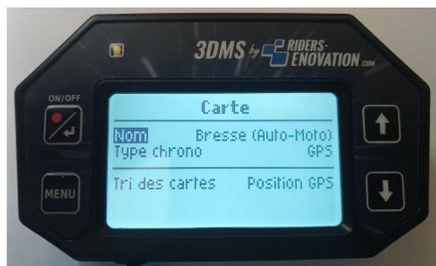
Par défaut, le champ "Type chrono" est "GPS". Mais si le 3DMS est équipé d'un capteur magnétique et si la carte est définie dans 3DMS Manager/Track Manager avec des bandes magnétiques, le champ "Type chrono" peut être modifié à "Magnétique".
