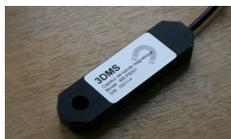
Le capteur magnétique étanche doit être monté sur la moto à une distance du sol de 20cm maximum afin de détecter le passage du véhicule sur les bandes magnétiques pouvant équipées les circuits.
